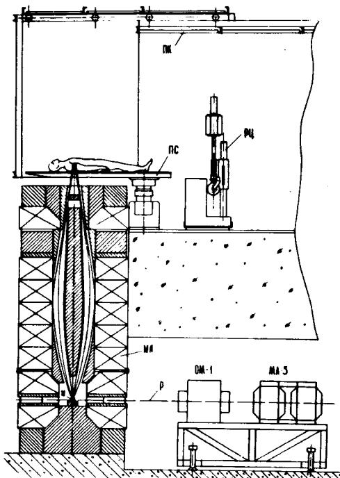
Схема формирования пи-мезонного пучка. р — протонный пучок, М — мезонообразующая мишень, МЛ — широкогольная магнитная линза, ПС — стол для фиксации пациента, РЦ — рентгеновский центратор, ПК — процедурная кабина для радиотерапии.
